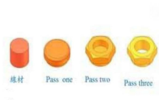
圖 3 各道次成型鍛件
